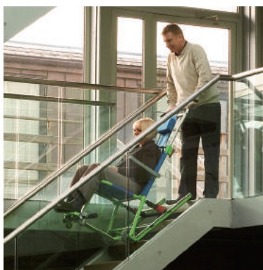
11. Excel chair 下部Vベルトが階段の2段目にかかるまでしっかり Excel chair を押し出してください。
